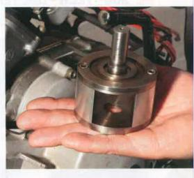
CILINDRO VALVOLA. La valvola di Federici è costituita da un cilindro asolato trasversalmente metrico che ruota a metà giri rispetto all'albero motore. Problematica chiave quella dell'autopulizia affrontata e risolta con sistemi sui quali è stato chiesto un secondo brevetto esteso anche al raffreddamento di tutto il sistema. Una volta industrializzato il gruppo valvola non avrebbe secondo l'inventore dei costi importanti; assenti i problemi da usura visto che non vi sono superfici a contatto.
