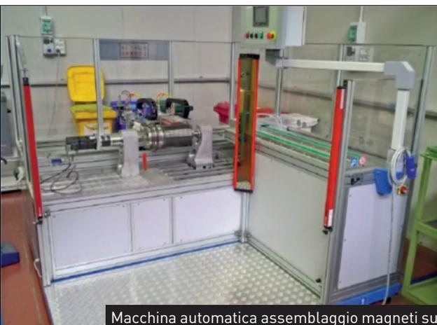
Macchina automatica assemblaggio magneti su rotori.
