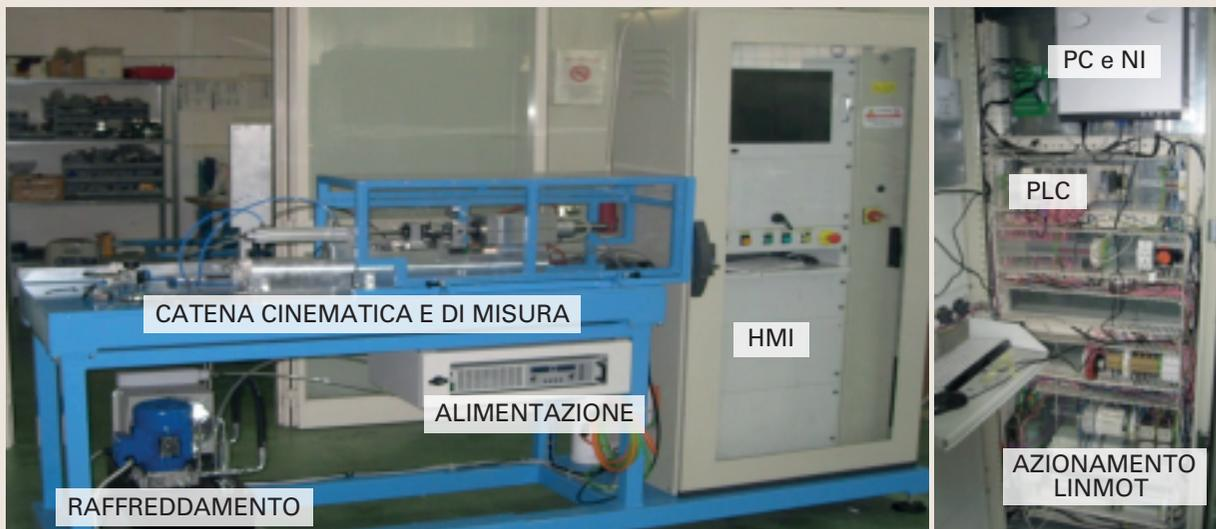
**Fig. 1** - Architettura del banco.
