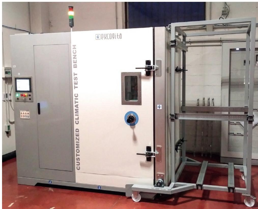
Vista camera termostatica insieme alla struttura (o porta) carrellata di chiusura frontale dove vengono disposti elementi mobili per il posizionamento del Test Equipment il quale, a seconda dei casi, può essere a cura del cliente o realizzato direttamente dall'azienda.
