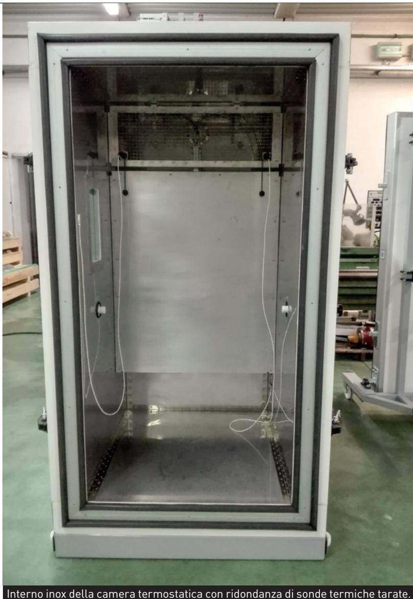
Interno inox della camera termostatica con ridondanza di sonde termiche tarate.
