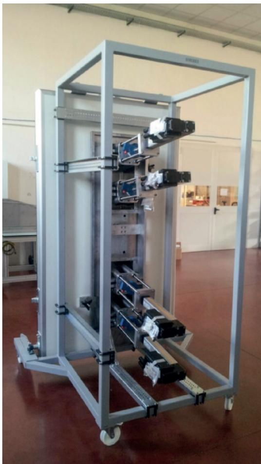
Esempio di porta carrellata con Dut montato.
