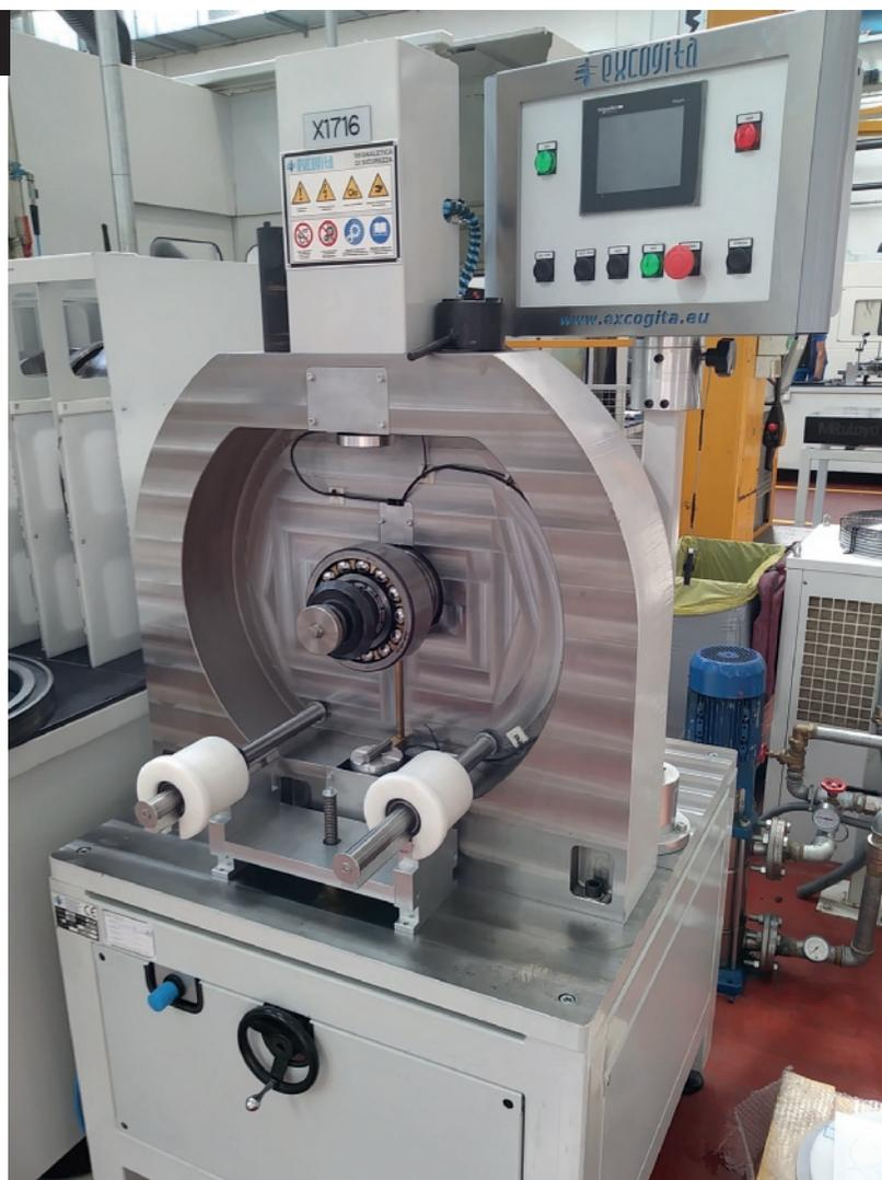
zo, sono necessari metodi diversi per creare il campo di smagnetizzazione (bobine di smagnetizzazione, gioghi smagnetizzanti, ndr)».
