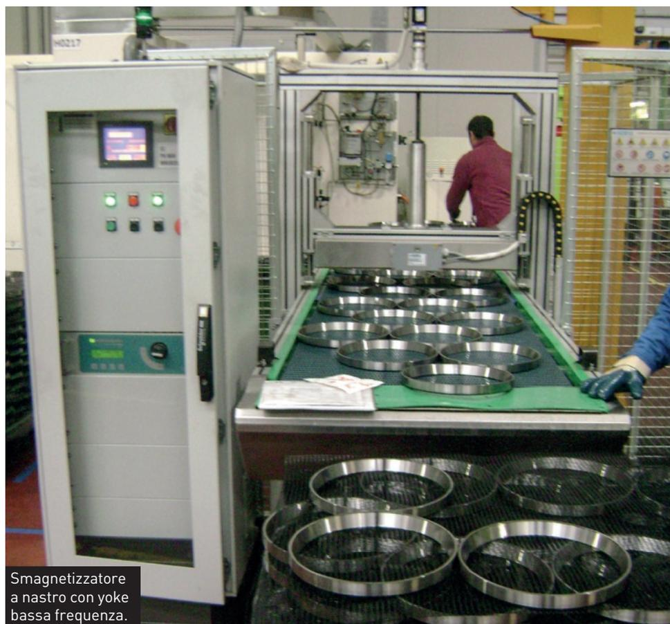
Smagnetizzatore a nastro con yoke bassa frequenza.
