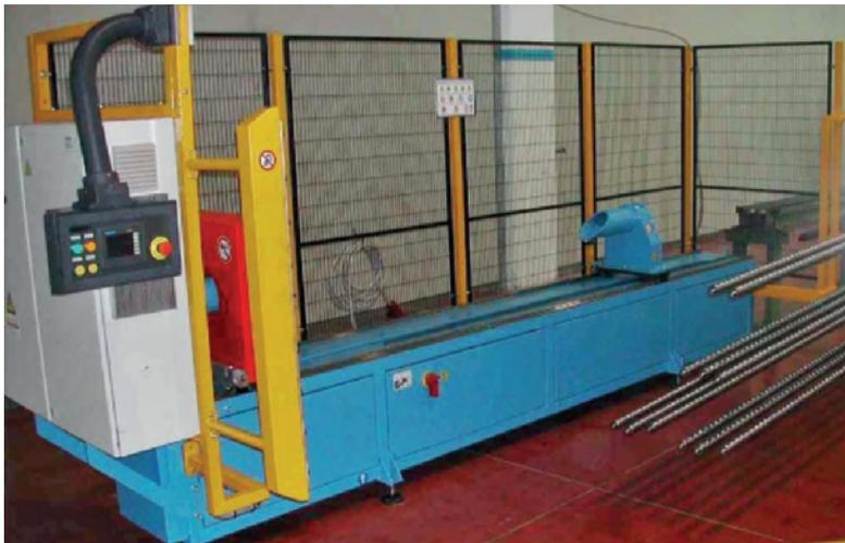
Smagnetizzatore coil a tunnel.
