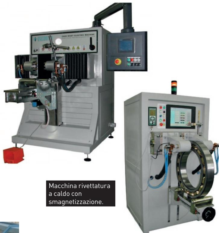
Macchina rivettatura a caldo con smagnetizzazione.
